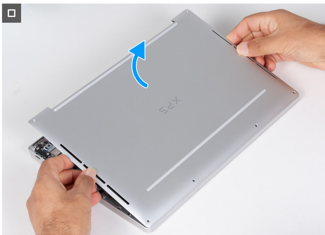
Rysunek 15. Wymontowywanie pokrywy dolnej
