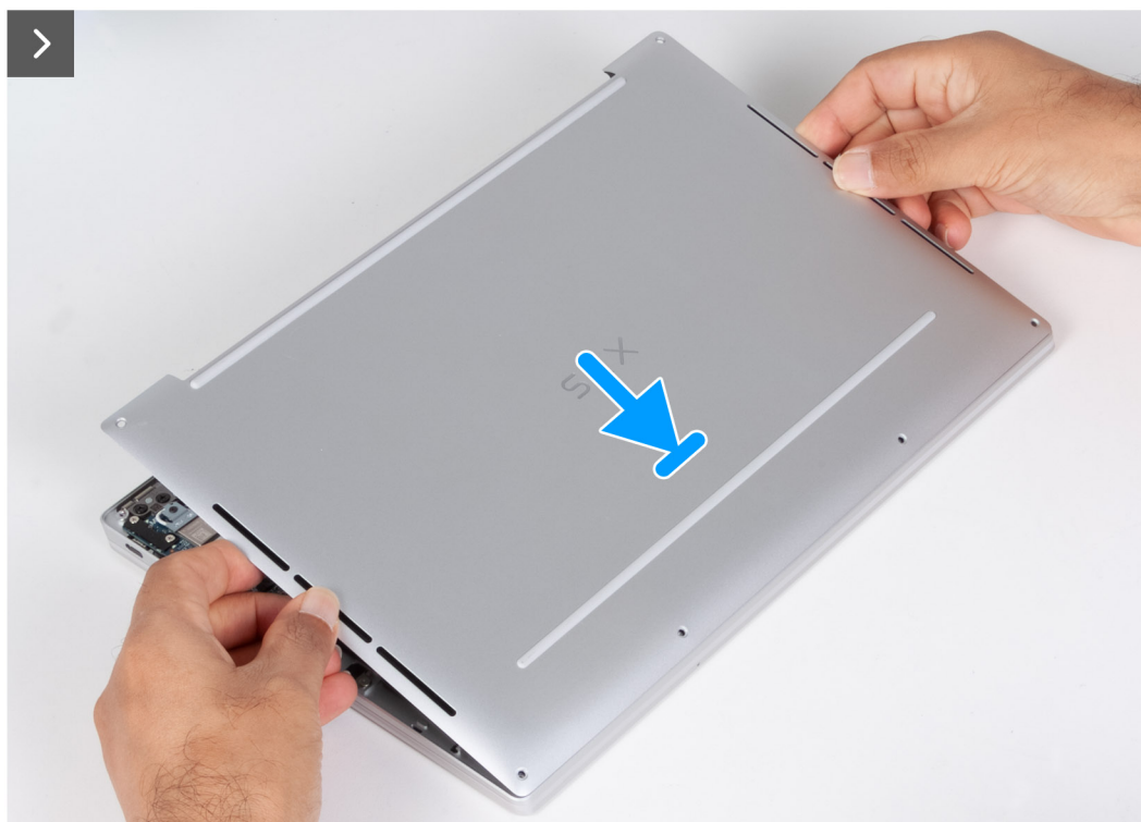
Rysunek 16. Instalowanie pokrywy dolnej
