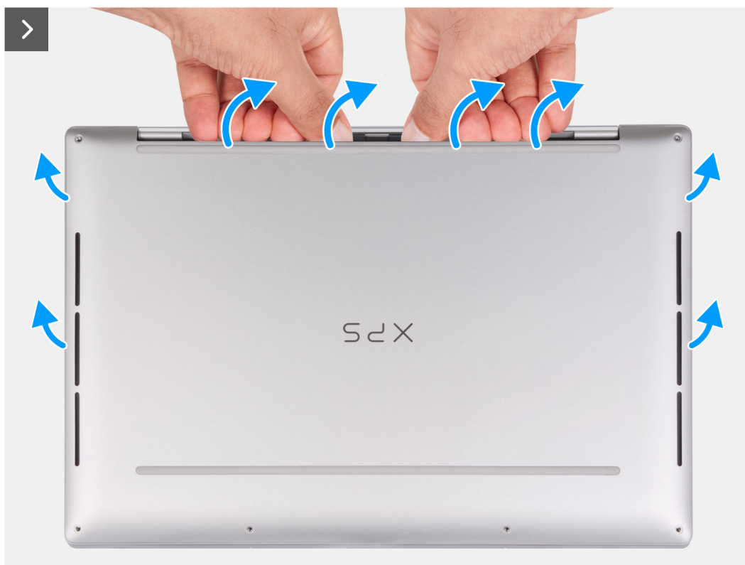
Rysunek 14. Wymontowywanie pokrywy dolnej
