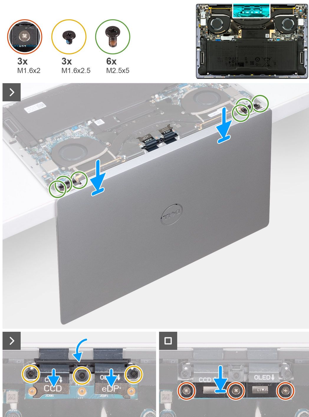
Rysunek 35. Instalowanie zestawu wyświetlacza
