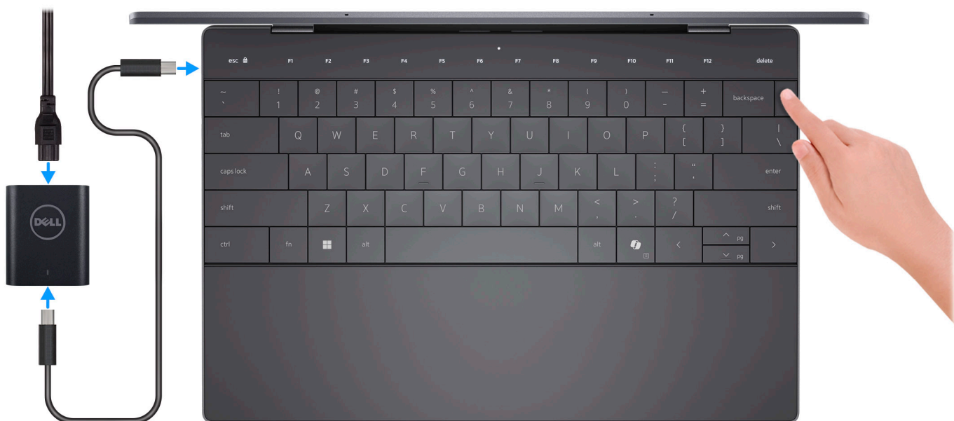
Rysunek 7. Podłącz zasilacz i naciśnij przycisk zasilania.
