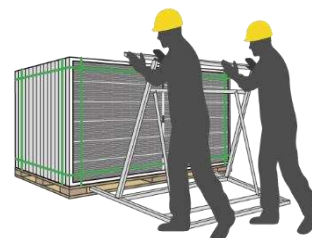
3) Umieść podstawkę, która jest wyższa lub szersza niż moduł, aby uniknąć uderzenia i uszkodzenia szkła.
