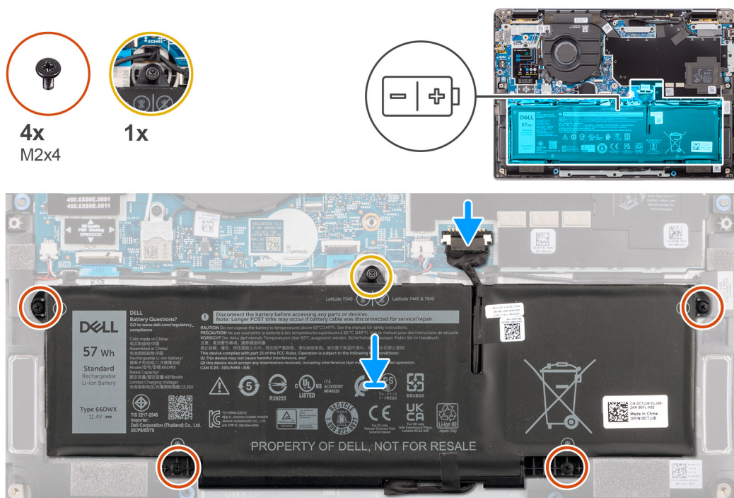
Rysunek 32. Instalowanie baterii 4-ogniowej
