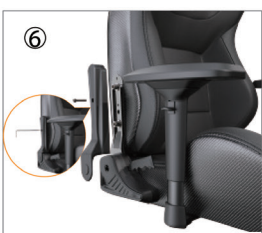
6 Zamontuj osłonę boczną Załóż pokrywę boczną i zabezpiecz ją dwiema śrubami M6. Uwaga: Należy zwrócić uwagę na różnicę między lewą i prawą osłoną boczną. W skórze nie jest widoczny żaden otwór. Otwór znajduje się od wewnątrz. Załóż pokrywę boczną i przykręć ją przez skórę.
