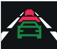
1. kontrola niebezpiecznej bliskości obiektu
