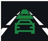
3. ostrzeżenie o rozpoczęciu ruchu obiektu znajdującego się przed nami
