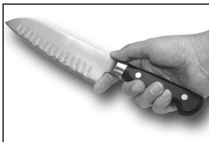
Rysunek 12. Jeśli twoje ostrze ma sporą brodę, to pomocne może być umieszczenie za nią palca podczas ostrzenia.
