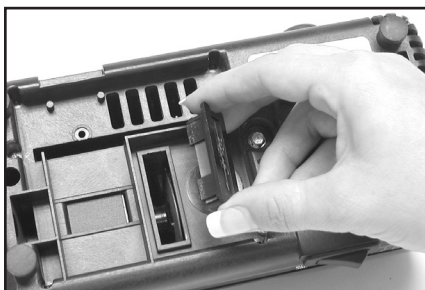
Rysunek 14. Zdejmowanie osłony pod podstawą w celu wyczyszczenia z pyłu metalowego (patrz Czyszczenie i Konserwacja).
