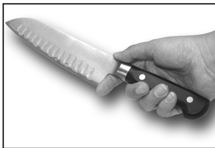
Abbildung 12. Wenn Ihre Klinge über eine ausgeprägte Fingermulde verfügt, kann es hilfreich sein, wenn Sie Ihren Finger beim Schärfen, wie abgebildet, dahinter platzieren.
