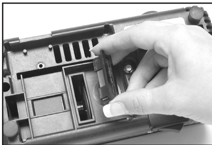
Abbildung 14. Abdeckung auf der Unterseite entfernen, um das Gerät von Metallstaub zu reinigen (siehe Abschnitt „Normale Wartung“).
