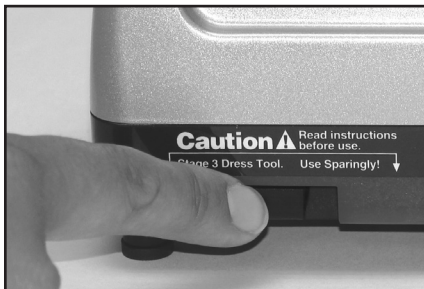
Rysunek 11. Dyski na etapie 3 mogą być czyszczone, jeśli jest to konieczne. Częste czyszczenie/poprawa grozi przedwczesnym zużyciem dysków.
