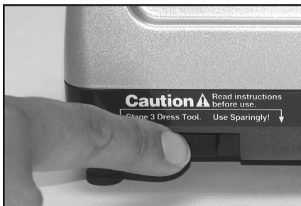
Abbildung 11. Wiederaufbereitungswerkzeuge sparsam einsetzen (siehe Anweisungen auf der nächsten Seite).
